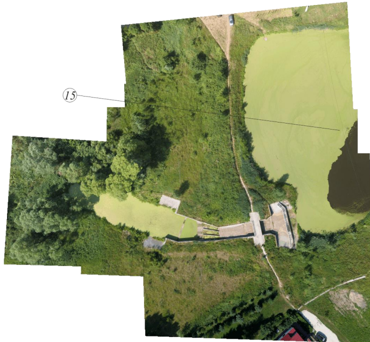
Рис. 7 – Ортофотопланы гидротехнических сооружений с искажениями на границах изображений: 15 – нестыковки на границах изображений
