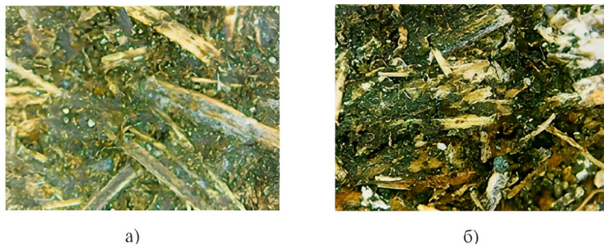
Рисунок 1 - Микрофотографии лицевой поверхности образцов ПБС: а) — до испытаний; б) — после испытаний на биоразлагаемость
