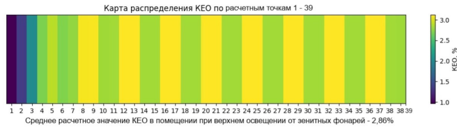
Рисунок 5 - Среднее расчетное значение КЕО в помещении для содержания кроликов DOI: https://doi.org/10.60797/JAE.2026.70.10.5
