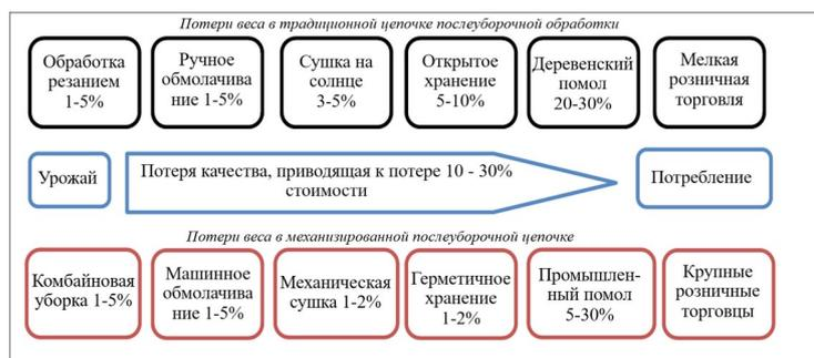
Рисунок 1 - Расчетные потери (вес и качество) в цепочке послеуборочной обработки семян зерновых культур
