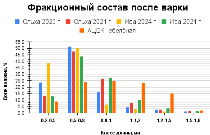
Рисунок 4 - Фракционный состав после варки по волокну целлюлозы, полученной из щепы ручного изготовления из ольховой и ивовой древесины DOI: https://doi.org/10.60797/JAE.2025.55.15.8
