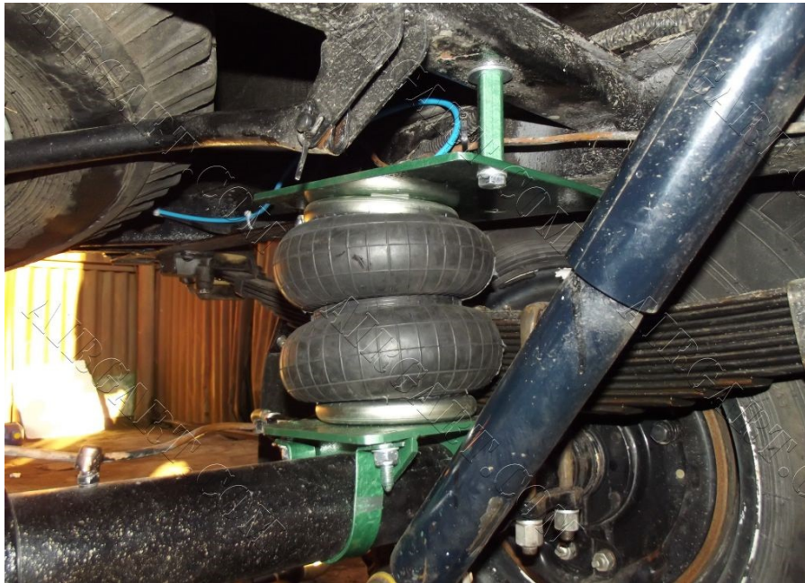
Рисунок 2 - Пневматическая подвеска на автомобиле УАЗ-3303 DOI: https://doi.org/10.23649/JAE.2024.43.7.2
